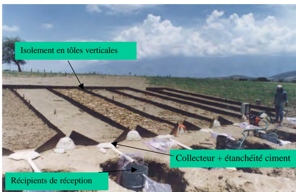
Figure 5 : Photo d'illustration de lots de ruissellement de très simple confection avec isolement en tôles verticales, collecteur en tôle pliée et bidons de 200 litres en réceptacle.
