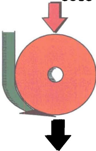
← GRAND DISQUE OUVREUR À L'AVANT, ÉQUIPÉ D'UN COUTRE DROIT QUI DISTRIBUE L'ENGRAIS SOUS LA LIGNE
