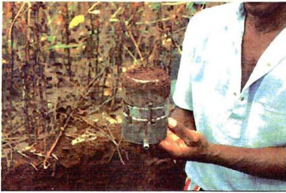
45. Cylindres d'échantillonnage *in situ*
