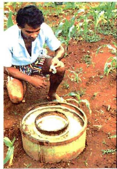
46. Méthode de double anneau pour mesure de la vitesse d'infiltration de l'eau *in situ*
