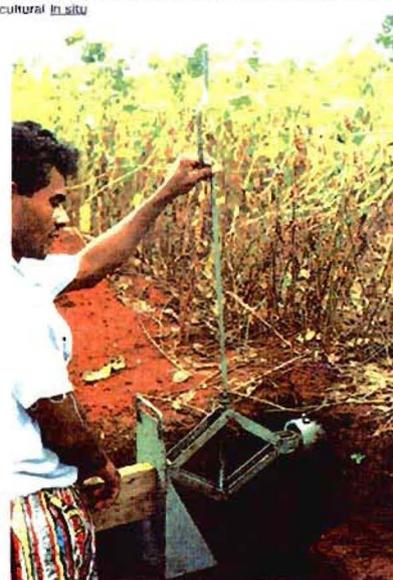
44. Matériel d'échantillonnage : Cylindres pour mesures IS, K, DA, DR sur échantillons non remaniés in situ
